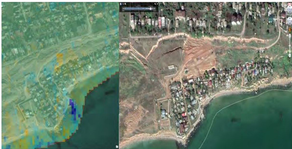
Рис. 2 Порівняння фази деформації (зліва) з оптичним зображенням (справа)
